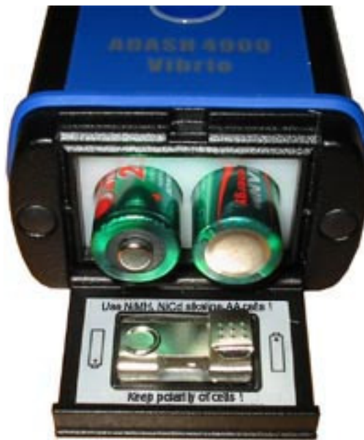
Colocación de las baterías
